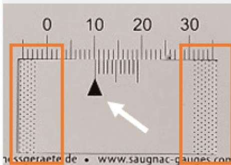
**Positionieren Sie das Noniusdreieck idealerweise zwischen 10 und 11**, wobei die beiden gesprenkelten Streifen rechts und links erscheinen. Das Ziel ist es, den Zug zu zentrieren. Versuchen Sie auf keinen Fall, das Noniusdreieck auf der 0 zu positionieren. Das ist unnötig und sehr schwer zu erreichen. Das Prinzip besteht nämlich darin, die Differenz zwischen zwei Messungen zu messen: Egal, wie hoch der Wert der ersten Messung ist, er ist der Punkt 0.
